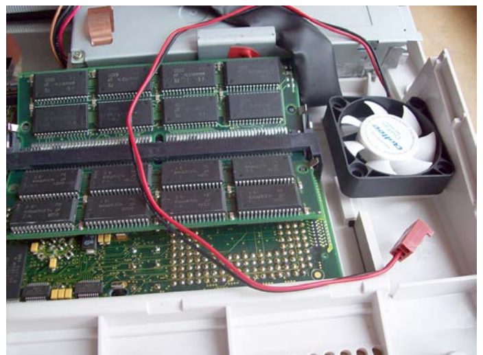
Dodatkowy wentylatorek w środku obudowy, tuż obok karty turbo (prawy dolny róg obudowy).
